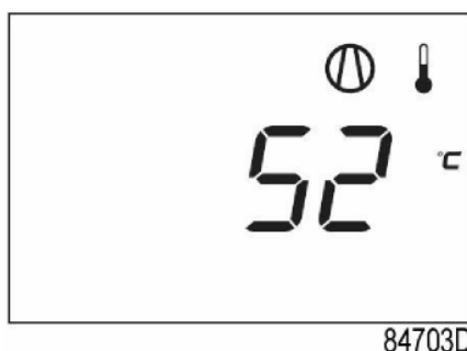
Pagină principală cu afișarea temperaturii (compresor oprit)
