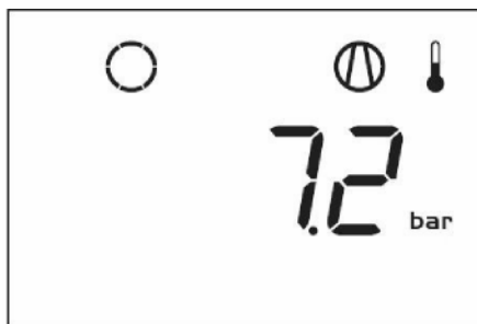
Pagină principală cu indicare a opririi și a temperaturii de pe ieșirea ansamblului
