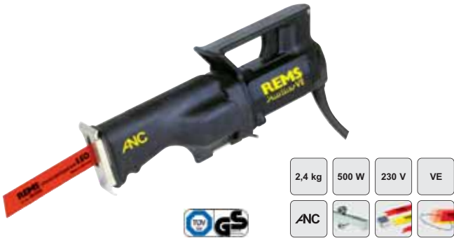
REMS Panther ANC VE. Ferăstrău alternativ electric universal, cu vario-electronic, pentru tăiere din mână până la 6", 250 mm. Livrat cu 1 lamă REMS universală de 150 mm. În cutie din carton. Art.Nr. 560025
