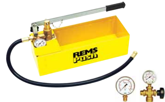
REMS Push. Pompă manuală pentru test de presiune până la 60 bar/870 psi, pentru instalații și rezervoare. Livrată cu manometru p ≤ 60 bar/870 psi, furtun de presiune de 1,5 m, cuplaj pe 1/2". Art.Nr. 115000
