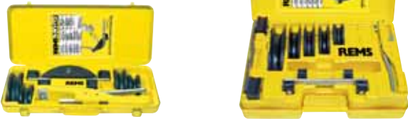
REMS Swing Set. Sculă de îndoii țevi Ø 10–32 mm, 3/8–7/8", până la 90°. Țevi din cupru moale Ø 10–22 mm, 3/8–7/8", s ≤ 1 mm, țevi din cupru moale îmbrăcate Ø 10–18 mm, 3/8–5/8", s ≤ 1 mm, țevi din oțel de tip C îmbracate ale sistemelor pressfitting Ø 12–18 mm, țevi de precizie din oțel moale Ø 10–18 mm, s ≤ 1 mm, țevi compozite multi-strat Ø 14–32 mm. Până la Ø 26 mm, livrarea cuprinde scula de antrenare, bara universală cu contrapiese, formatoarele specificate, în cutie metalică. Până la Ø 32 mm, livrarea cuprinde scula de antrenare, 2 bare universale cu contrapiese, formatoarele specificate, în valiză durabilă din plastic.
