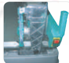
Buton pentru oprire incorporat in maner
